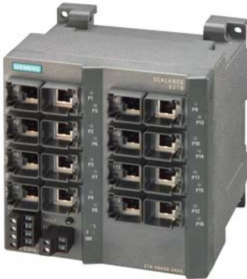
SCALANCE X216, managed IE Switch, 16x 10/100 Mbit/s RJ45 Ports, LED-Diagnose, Fehlermelde- Kontakt mit Set-Taster, redundante Spannungsversorgung, PROFINET IO Device, Netzwerk-Management, Redundanz-Manager integriert, inkl. elektron. Handbuch auf CD-ROM, C-PLUG optional
