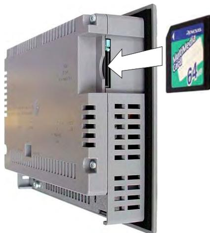
Beachten Sie beim Stecken der Speicherkarte, dass sich diese nur wie im Bild dargestellt in den Speicherkartenschacht stecken lässt. Wenn die Speicherkarte korrekt im Speicherkartenschacht steckt, ist der Speicherkartenhalter hinter der Speicherkarte eingerastet.
