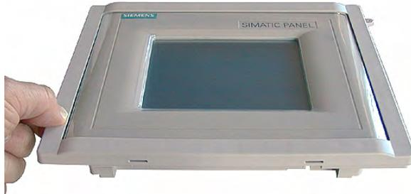
8. Bediengerät in den Einbauausschnitt einsetzen
