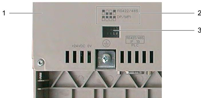
Bild 4-12 Lage des DIL-Schalters am OP 170B
