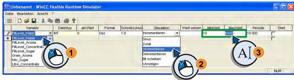
Der WinCC flexible Runtime Simulator wird über die gezeigte Simulationstabelle gesteuert. Projektierte Variablen können in der Spalte "Variable" ausgewählt und fortlaufend in Zeilen eingetragen werden. Die Eigenschaften der Variablen werden in den gelb hinterlegten Spalten "Datentyp" und "aktueller Wert" angezeigt. Die Einträge in den weißen Spalten sind die Einstellungen des Simulators und steuern den Ablauf der Simulation.
