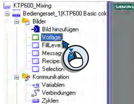
2. Legen Sie den Wechsel zum Bild "FillLevels" auf die Funktionstaste <F1>:
