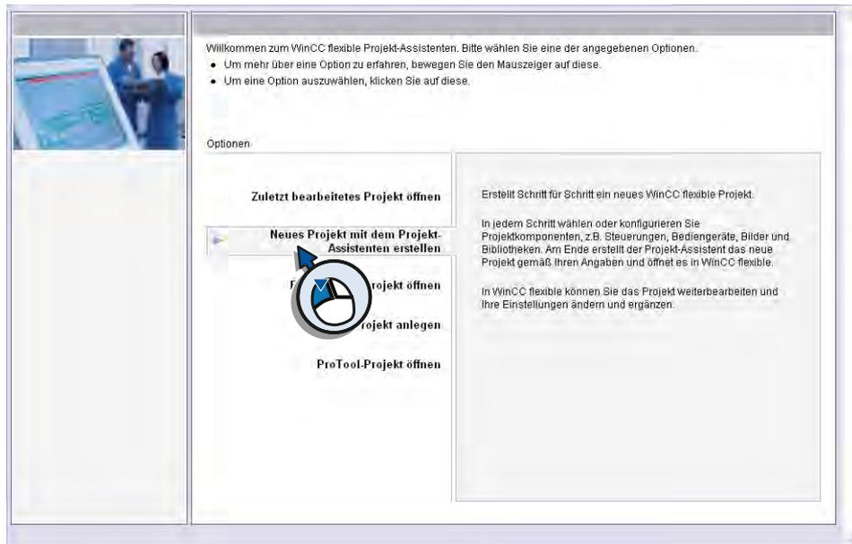
3. Um die Fruchtsaftmischanlage zu bedienen, benötigen Sie nur *ein* Bediengerät und *eine* Steuerung. Wählen Sie deshalb das Szenario "Kleine Maschine" und übernehmen Sie die Auswahl mit "Weiter".
