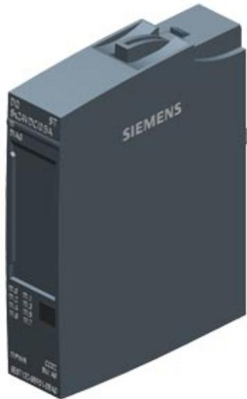
SIMATIC ET 200SP, Digitales Ausgangsmodul, DQ 8x 24V DC/0,5A Standard, Source Output (PNP,P-schaltend) Verpackungseinheit: 1 Stück, passend für BU-Typ A0, Farbcode CC02, Ersatzwertausgabe, Modul-Diagnose für: Kurzschluss nach L+ und M, Drahtbruch, Versorgungsspannung
