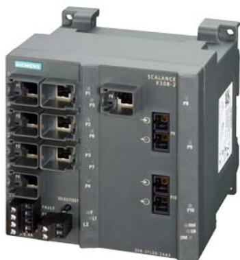
SCALANCE X308-2, managed plus IE Switch, 2x 1000 Mbit/s MM SC 1x 10/100/1000 Mbit/s und 7x 10/100 Mbit/s RJ45 Ports, LED-Diagnose, Fehlermelde- Kontakt mit Select/Set-Taster, PROFINET IO Device, Netzwerk- Management, integrierter Redundanz-Manager, Office Features (RSTP, VLAN, IGMP,...) C-PLUG im Lieferumfang
