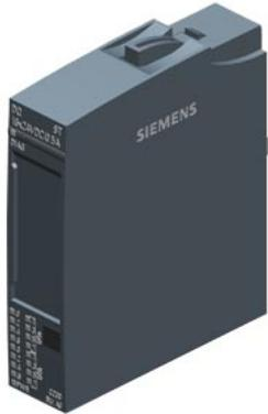
SIMATIC ET 200SP, Digitales Ausgangsmodul, DQ 16x 24V DC/0,5A Standard, Source Output (PNP,P-schaltend) Verpackungseinheit: 1 Stück, passend für BU-Typ A0, Farbcode CC00, Ersatzwertausgabe, Modul-Diagnose für: Kurzschluss nach L+ und M, Drahtbruch, Versorgungsspannung
