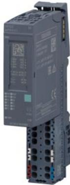
SIMATIC ET 200SP TM ECC 2xPWM ST Ladecontroller zum konduktiven Laden von Elektro- fahrzeugen gemäß IEC61851 mit 2 Ladeabgängen - 30°C...60°C 2x Control Pilot 2x Plug Present 2x DQ Schaltkontakt für Lastschütz als Open Collector; 2x DI für Rückmeldung Lastschütz oder Steckerverriegelung; 2x ACT für Steckerverriegelung passend für BU Typ BU20-P12+A0+4B und BU20-P12+A4+0B
