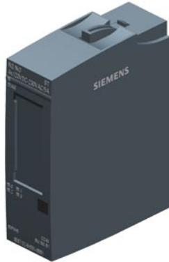
SIMATIC ET 200SP, Relaismodul, RQ NO 4x 120V DC..230VAC/5A ST, 4 Schließkontakte potenzialgetrennt, Verpackungseinheit: 1 Stück, passend für BU-Typ B0 oder B1, Farbcode CC40, Ersatzwertausgabe, Modul-Diagnose für: Versorgungsspannung
