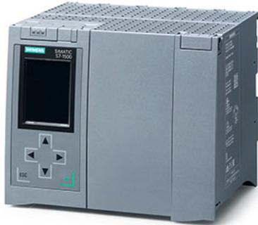
SIMATIC S7-1500F, CPU 1517F-3 PN/DP, Zentralbaugruppe mit Arbeitsspeicher 3MByte für Programm und 8MByte für Daten, 1. Schnittstelle: PROFINET IRT mit 2 Port Switch, 2. Schnittstelle: PROFINET RT, 3. Schnittstelle: PROFIBUS, 2 NS Bit-Performance, SIMATIC Memory Card notwendig
