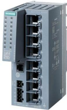
SCALANCE XC208G managebarer Layer 2 IE Switch; IEC 62443-4-2 zertifiziert; 8x 10/100/1000 Mbit/s; RJ45-Ports; 1x Konsolen-Port; Diagnose-LED; redundante Spannungsversorgung; Temp.-Bereich -40°C bis +70°C; Montage: Hut-/S7-Profileschiene/Wand Redundanzfunktionen; Office Features (RSTP, VLAN, ...); PROFINET IO-Device; Ethernet/IP-konform; C-PLUG Schacht;
