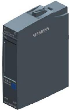
SIPLUS ET 200SP AI 4xU/I 2-w ST based on 6ES7134-6HD01-0BA1 mit Conformal Coating, -40...+70°C, analoges Eingangsmodul, passend für BU-Typ A0, A1, Farbcode CC03, Moduldiagnose, 16Bit, +/-0,3%
