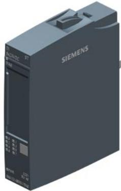
SIPLUS ET 200SP DI 8x24VDC Standard based on 6ES7131-6BF01-0BA0 mit Conformal Coating, -40...+70°C, digitales Eingangsmodul, passend für BU-Typ A0, Farbcode CC01, Sink Input, (PNP, P-lesend), Eingangstyp 3 (IEC 61131), Eingangsverzögerung 0,05..20ms Modul-Diagnose für: Kurzschluss Geberversorgung, Drahtbruch, Versorgungsspannung
