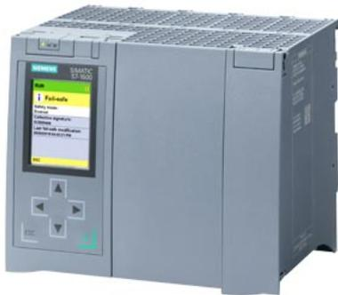
SIMATIC S7-1500TF, CPU 1516TF-3 PN/DP, Zentralbaugruppe mit Arbeitsspeicher 3 MB für Programm und 7,5 MB für Daten, 1. Schnittstelle: PROFINET IRT mit 2 Port Switch, 2. Schnittstelle, Ethernet, 3. Schnittstelle, PROFIBUS, 6 ns Bit-Performance, SIMATIC Memory Card notwendig
