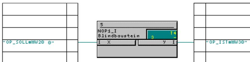
Bild 3-123 Schreiben von Funktionsbaustein-Anschlüssen
